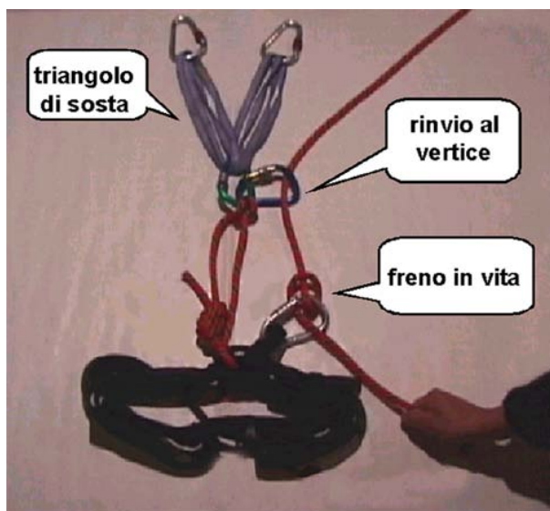
Figura 1.4: Organizzazione dell'assicurazione ventrale.
